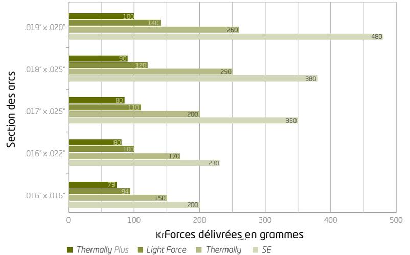
Tableau comparatif des forces délivrées par les arcs NiTi-Thermally, Thermally-plus, Lightforce
